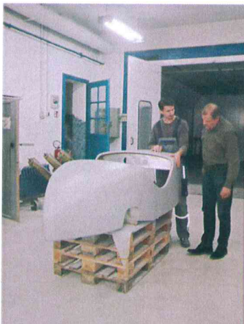
Lackierarbeiten von 09/18 bis 01/19 Oktober 2018 Grundierung ist fertig (Robert Johannis (li))
