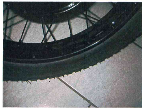
Räder 11/2016 Neueinspeichung Halbbettfelgen mit versetzter Speichung Radspannerei Palitzsch, 15.11.2016
