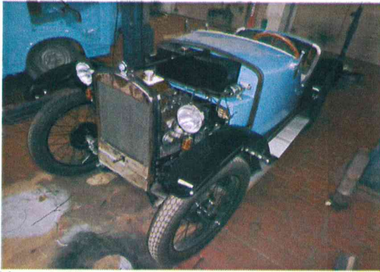
Komplettierung 01 bis 02/2019 Dessau Zusammenbau, Elektrik, Keder, Trittbretter
