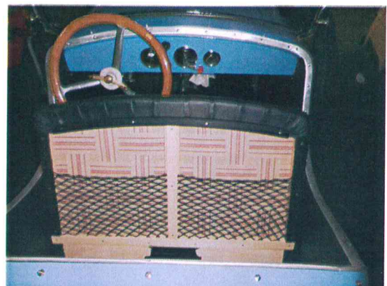
im März 19 wurden in Angelroda noch einige Details komplettiert (Netzgitterablage und Persenninghalterungen)
