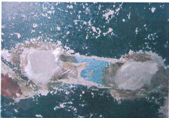
Spuren der hellen blauen Farbe mehrfach an der Karosserie nachzuweisen
