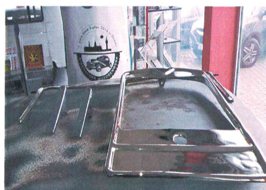
Teile zurück vom Vernickeln Frontschürze, Fensterrahmen, Rahmenhalterungen
