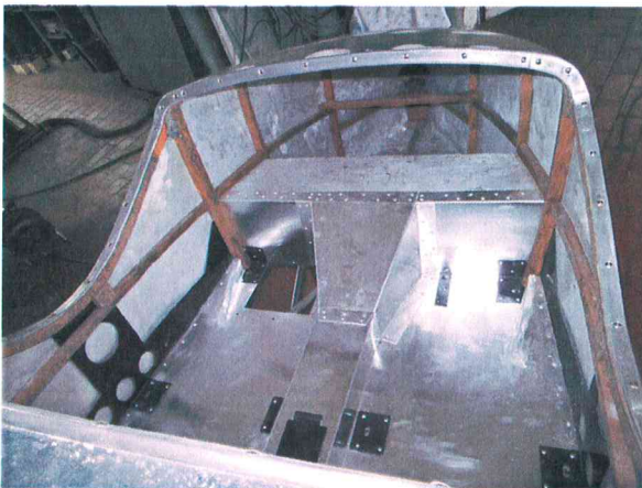
Alukarosse + Holzgestell 11/2016 - 01/2017 28.01.2017 Kaarst - Boden der Alukarosse neu, alte Holzgestellteile überarbeitet
